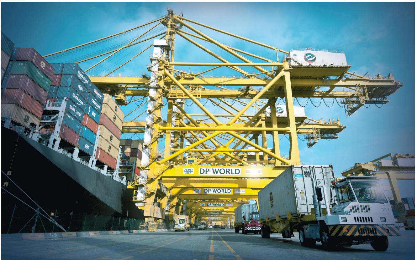
Im Seehafen Dschabal Ali sorgt das AOS-System von SICK für einen kollisionsfreien und effizienten Containerumschlag. Für das AOS-System werden Laserscanner vom Typ LMS511 und LMS111 verwendet.
