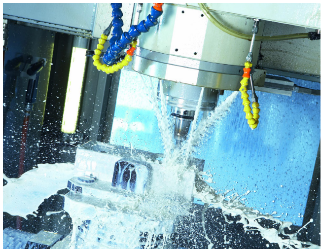
Fräsen unter Einsatz von Kühlschmierstoffen
