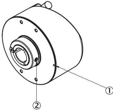
Внимание! При смонтированном упоре против проворачивания маркировка нулевого импульса может быть закрыта эти упором
