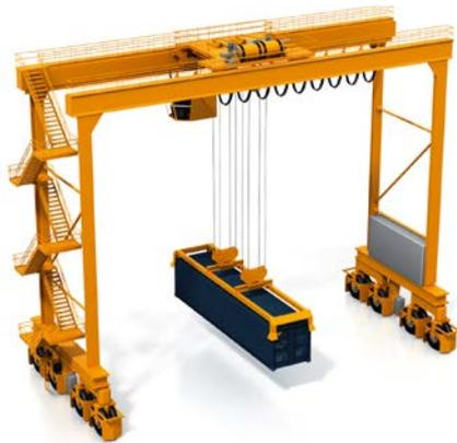
Der rädergeführte Portalkran (Rubber Tyred Gantry crane, RTG crane) ist eine sehr flexibel einsetzbare Verladeausrüstung und kann beim Containerhandling auch die Gassen des Containerstapelbereichs wechseln.
