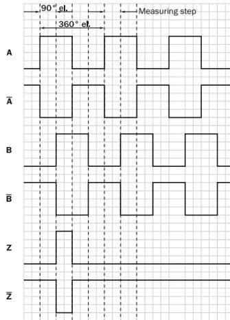
По часовой стрелке, если смотреть со стороны вала энкодера «А», ср. габаритный чертеж. Интерфейсы G, P, R исполняют только каналы A, B, Z.
