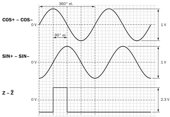
При повороте вала по часовой стрелке, если смотреть в направлении А (см. размерный чертеж)
