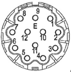
Ansicht des Gerätesteckers M23 am Encoder
