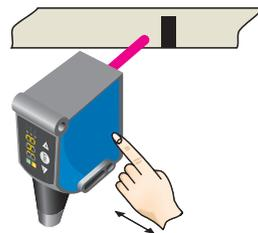
Bei der Einstellung der zu erfassenden Kontraste blinkt „2nd“ auf. SET-Taste drücken. Die Quality of Teach wird angezeigt.
