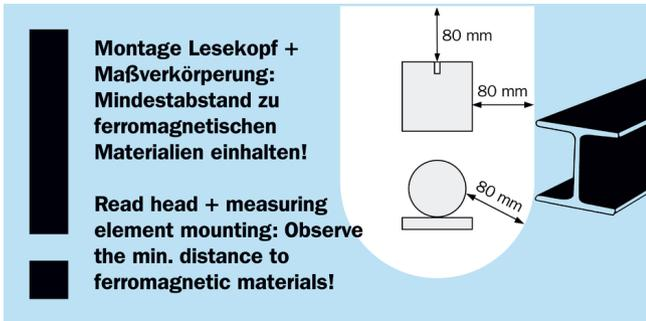
Не используйте в качестве монтажной подкладки считывающей головки ферромагнитный материал. Соблюдать расстояние до ферромагнитного материала (например, железа) 80 мм.
