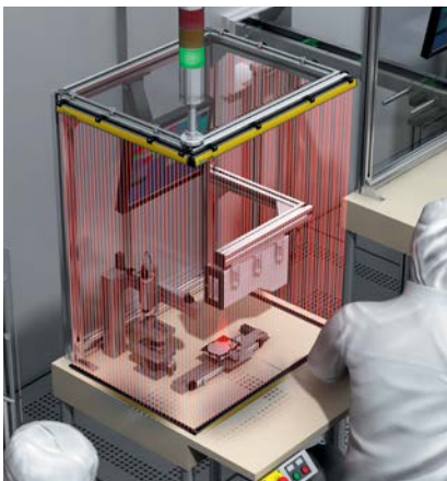
라이트 커튼 miniTwin4를 이용한 지능적 접근 안전 솔루션으로 최대 생산성 보장.
