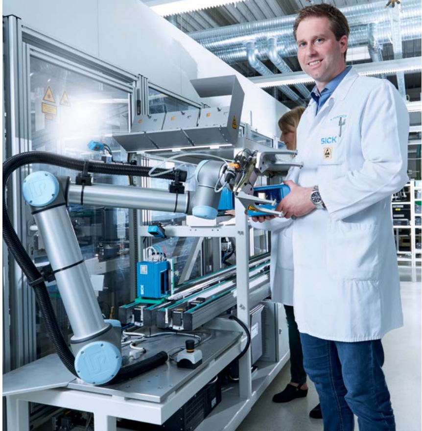
로봇에 설치되는 2D 카메라 Inspector PIM60의 도움으로 로봇은 사전에 지정된 물체의 위치를 감지한다.
