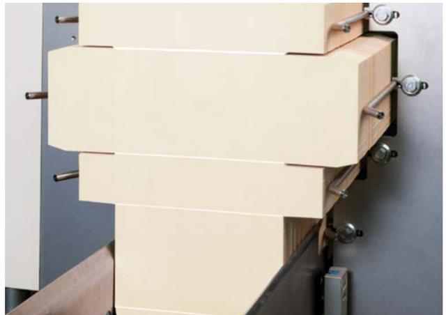
Es soll sichergestellt werden, dass die Öffnung durch die Kartons verschlossen ist. Die Lösung: der Sensor WTB4-3 mit Selbstüberwachungsfunktion. Ist die Öffnung nicht verschlossen oder liegt ein Sensorfehler vor, wird dies der Steuerung gemeldet.
