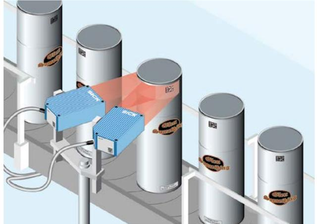
Data-Matrix-Code gewährleistet die sortenreine Verpackung und trägt zur Steigerung der Qualität im Verpackungsprozess bei. Im Durchlauf bei Geschwindigkeiten bis zu 3 m/s identifiziert der Codeleser ICR845-2 sicher den Code ohne den Durchsatz negativ zu beeinflussen.
