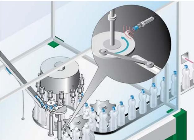
Der induktive Sensor IMF12 detektiert verschiedene Positionen am Übergabeteller vor dem Versiegeln und ist aufgrund seines Aufbaus/Designs reinigungsbeständig.
