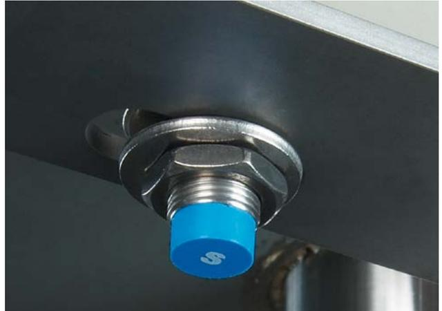
Positionserfassung während der Maschinenprozesse sind die Aufgaben, die die IME12 an den Form-, Füll- und Verschleißmaschinen für Becher wahrnehmen. Zur einfachen Identifikation der Ausgangsfunktion sind sie mit S (Schließer) oder Ö (Öffner) bedruckt.
