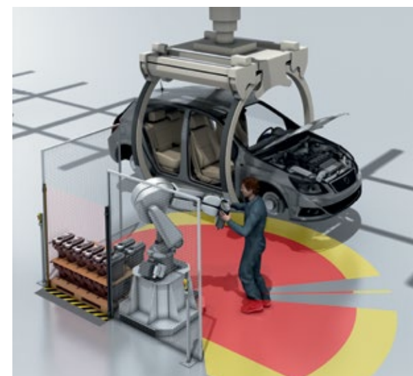
Già oggi i robot lavorano senza recinzione perimetrale di protezione.
