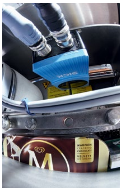
Il sensore di visione verifica la presenza della data di scadenza.
