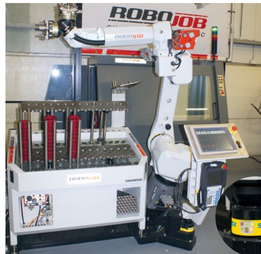
Caricamento automatico di una macchina utensile con una soluzione robotizzata di RoboJob.
