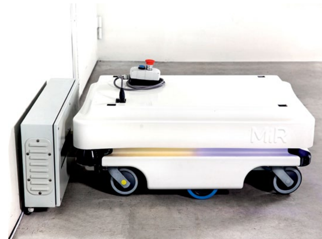
MiR100: il piccolo trasportatore su quattro ruote a una stazione di aggancio.
