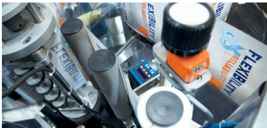
Posizionamento preciso di nastri continui e singoli oggetti – senza marcature ma sulla base dell'immagine.
