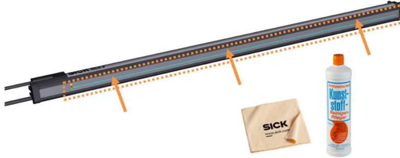
Fig. 49 : Nettoyage - Rideaux de détection
