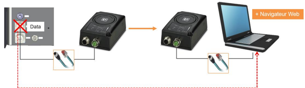
Fig. 39 : Raccordement du module WLAN au PC de configuration
