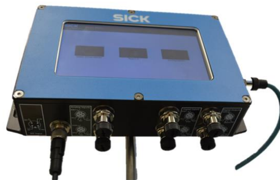
Fig. 52 : Remplacement de composants - Afficheur (débrancher les câbles)
