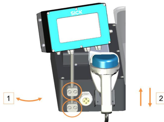
Fig. 40 : Réglage de la position d'affichage et de fonctionnement de l'afficheur
