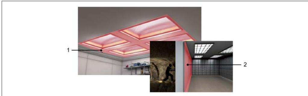
Abb. 18: Deckenüberwachung und Durchbruchschutz
