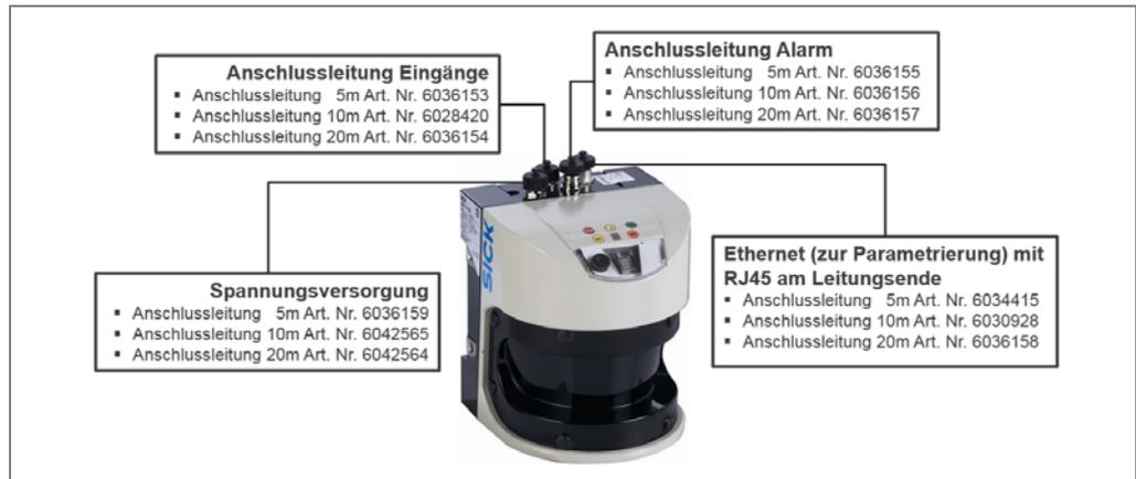
Abb. 76: Anschlussleitungen LMS531 Lite (mit Artikelnummer)
