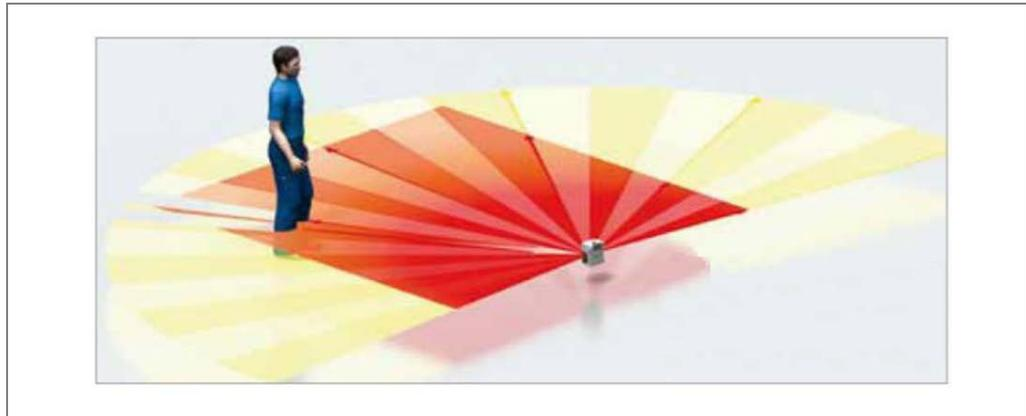
Abb. 1: Funktionsprinzip 2D-Laserscanner
