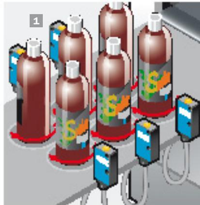
**1** Lumineszenztaster LUT2 erkennen die fluoreszierenden Druckmarken auf den Etiketten der PET-Flaschen zu deren Ausrichtung. Sind alle Flaschen korrekt ausgerichtet, d.h. mit den Hauptetiketten nach außen, so dass diese dem Konsumenten ins Auge fallen, werden die Flaschen in den Schrumpftunnel zur Folienumwicklung transportiert.
