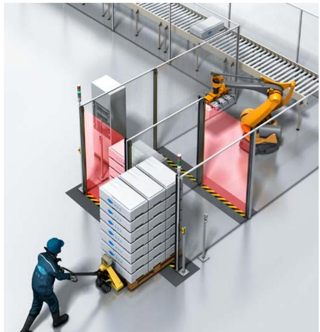
Abb. 2.3 Schleusenapplikation mit zwei Schleusen im Tiefkühlbereich.
