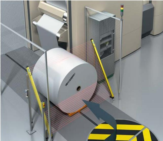
Hinweis: Im ausgeblendeten Bereich vergrößert (verschlechtert) sich das Detektionsvermögen des Sicherheits-Lichtvorhangs und damit der Mindestabstand. Die sogenannte wirksame Auflösung berücksichtigt die ausgeblendeten Strahlen und damit die Größe des ausgeblendeten Bereichs während des Materialtransports.
