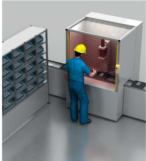
Abb. 1.3 Geringe Öffnungsgröße bei distanzierender Schutzeinrichtung.
