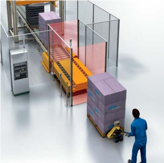
Abb. 2.1 Schleusenapplikation mit einer Schleuse und Hubwagentisch.
