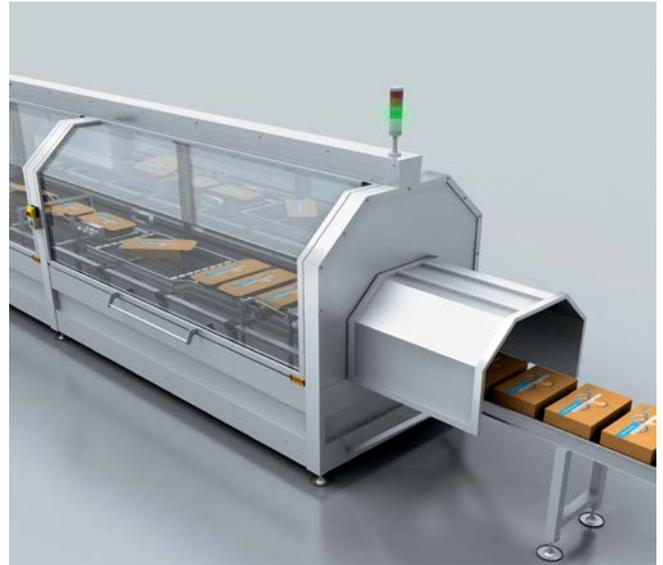
Abb. 1.1 Tunnel als distanzierende Schutzeinrichtung.
