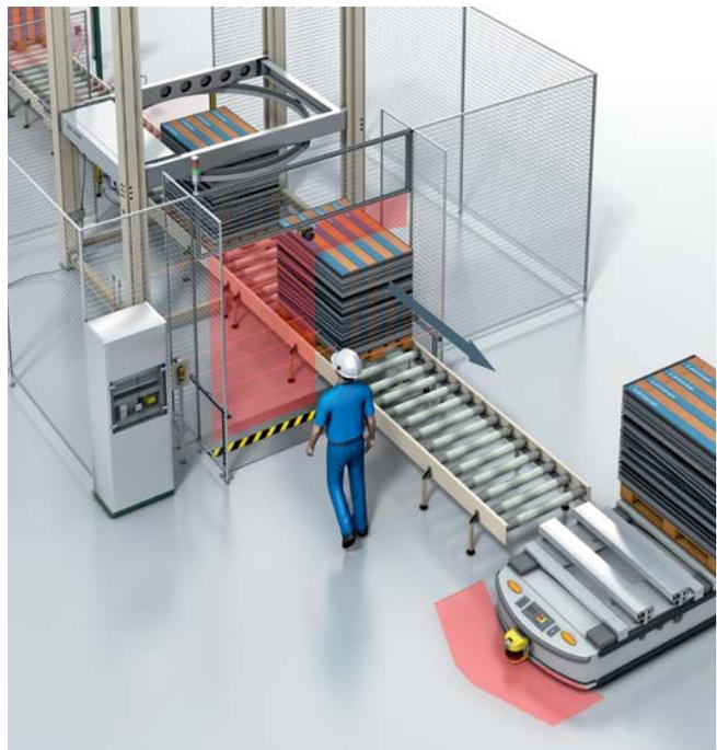
Abb. 4.2.4 Schutzfeldumschaltung mit einem Sicherheits-Laserscanner und vier parallel angeordneten Sensoren mit Zeitüberwachung.
