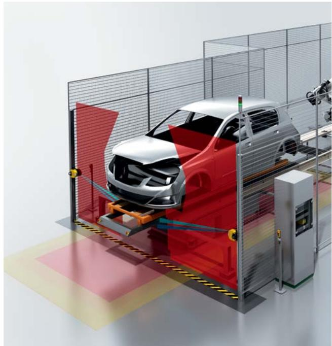
Abb. 4.2.2 Sonderform der Schutzfeldumschaltung ohne Umschaltungssensoren.
