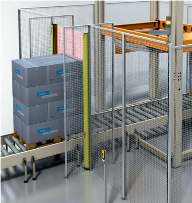
Abb. 4.1.1 Schutzfeld-Überbrückung mit vier parallel angeordneten Sensoren und Zeitüberwachung
