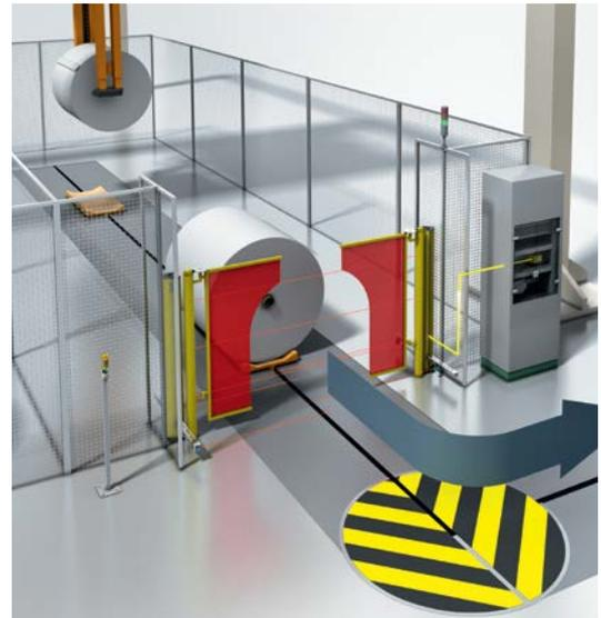
Abb. 4.1.3 Schutzfeld-Überbrückung mit vier gegenüberliegend angeordneten Sensoren und Zusatzsignal
