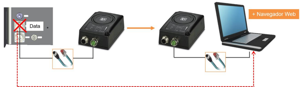
Fig. 39: Conexión del módulo WLAN al PC de configuración
