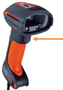
Fig. 45: Lectura de código de barras con pistola lectora de códigos
