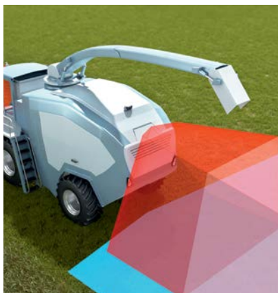
Prévention des collisions au niveau de la faucheuse-hacheuse.
