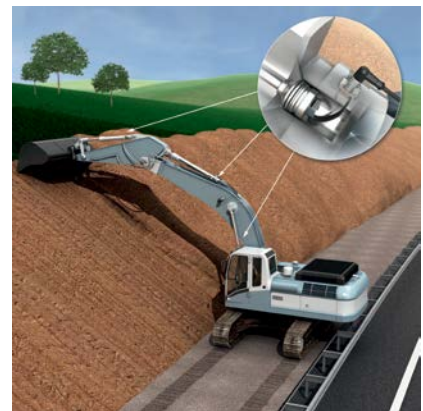
Façonnage de talus d'autoroute : entièrement automatique et au degré près.
