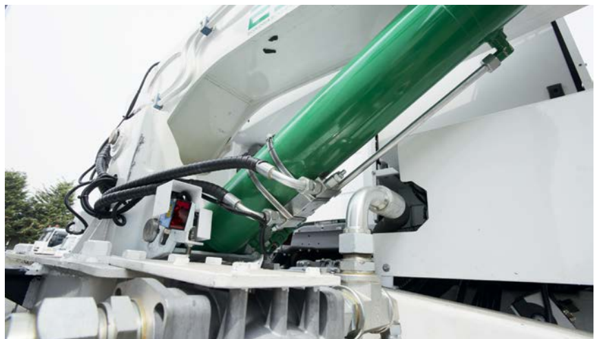
Le capteur de distance DT50-2 fournit les informations de base.
