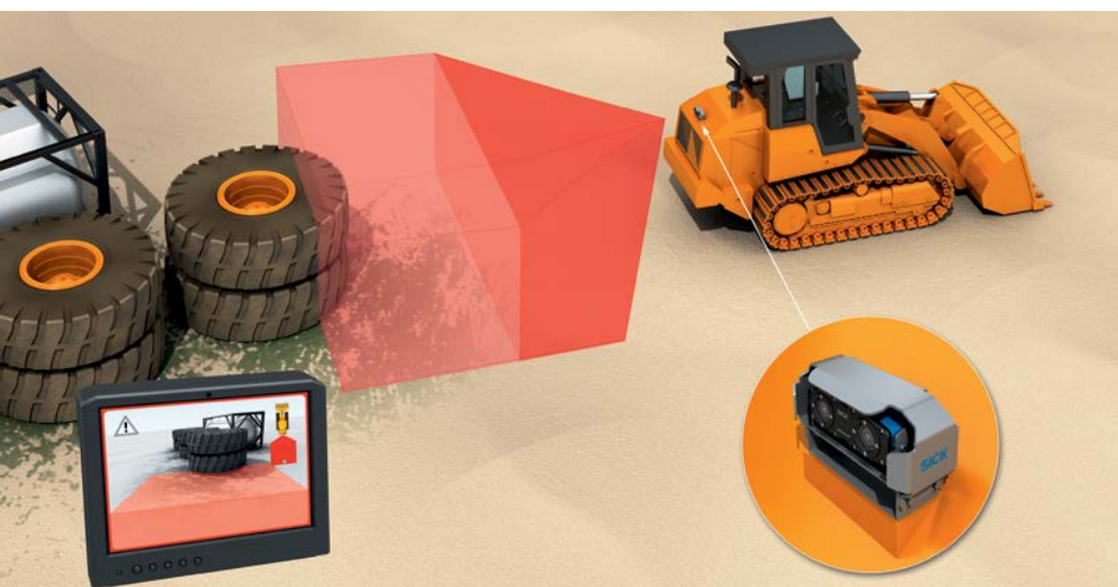
Le capteur de vision 3D Visionary-B détecte les personnes et les objets situés dans l'angle mort et prévient le conducteur de leur présence.
