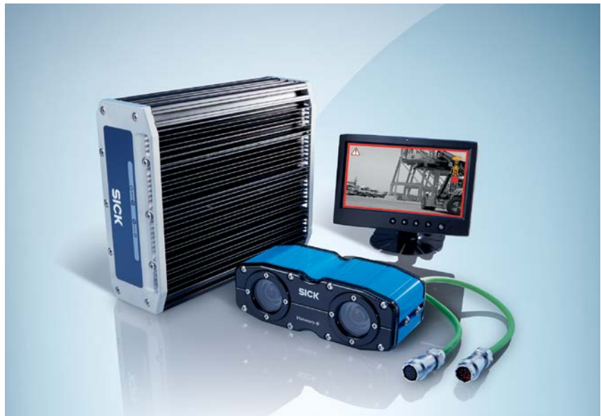
Système d'aide à la conduite Visionary-B pour la prévention des collisions dans les environnements difficiles.
