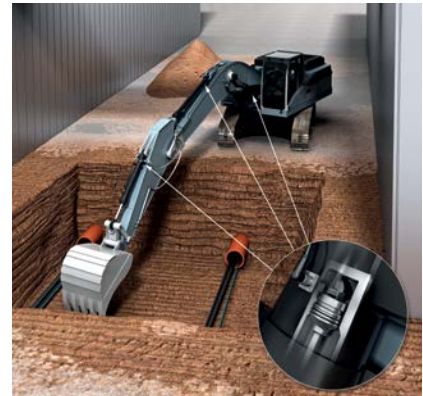
Contrôle de la profondeur : les câbles ne sont plus endommagés.
