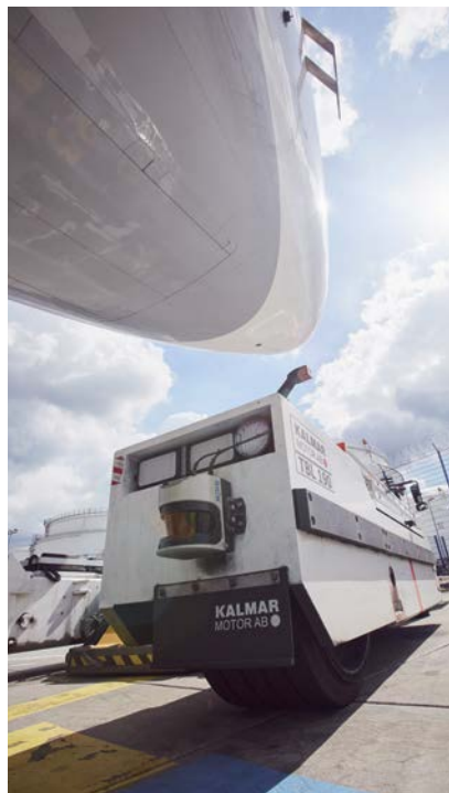
Le système d'aide à la conduite APS aide le conducteur de tracteur à déplacer les avions.
