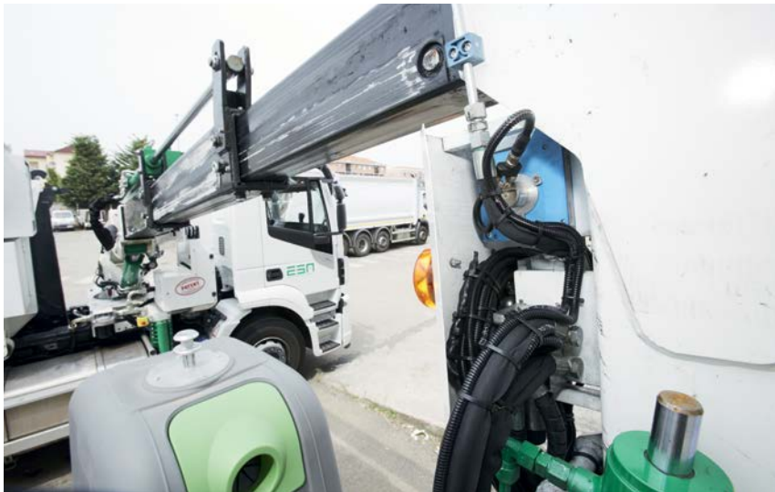
Le codeur à câble mince EcoLine enregistre efficacement le parcours de sortie du grappin.
