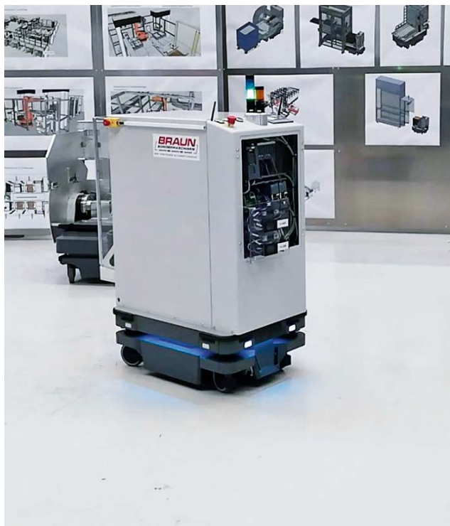
El BS Trayshuttle recoge de forma autónoma los pequeños portadores de carga (KLT) o las pilas de bandejas de un paletizador y los coloca de nuevo en otro paletizador.
