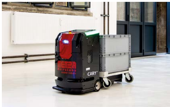
El CARY es un minipilador autónomo que transporta carros logísticos cargados.
