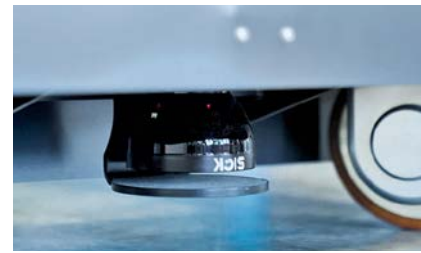
Para la localización y la navegación, hay tres escáneres láser de seguridad microScan3 situados bajo el suelo del vehículo.
