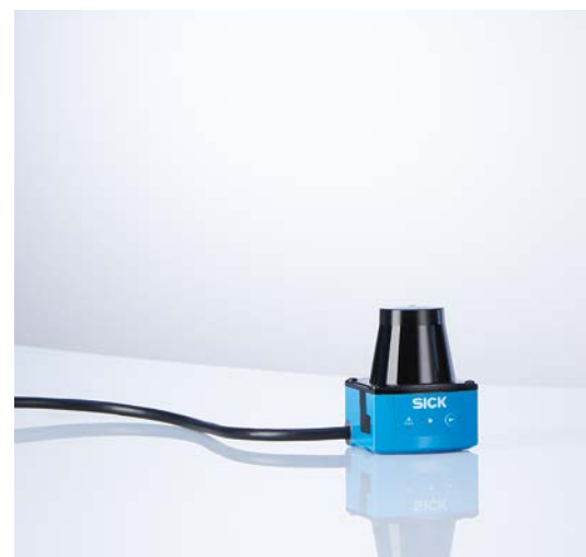
La cooperación entre humanos y robots es posible gracias a soluciones de sensores como los sensores 2D-LiDAR de la serie TiM.
