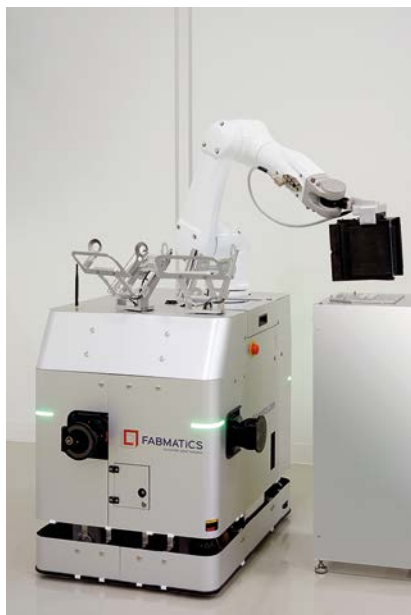
HERO®FAB combina un sistema robótico establecido, limpio y seguro con una innovadora plataforma de transporte sin conductor.
