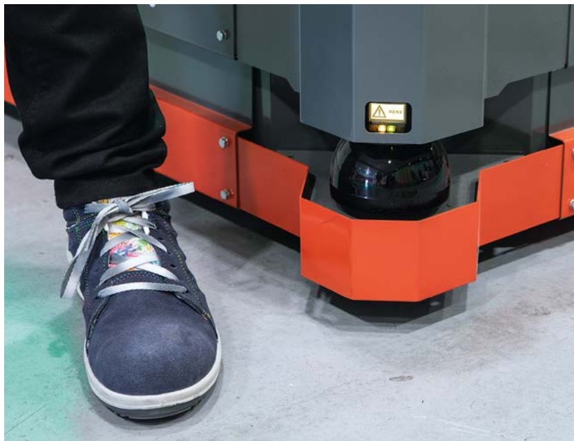
El escáner láser de seguridad microScan3 garantiza un funcionamiento óptimo de los AMR y ofrece una gran resistencia a la suciedad, el polvo y la luz solar gracias a la innovadora tecnología de escaneado safeHDDM®.
