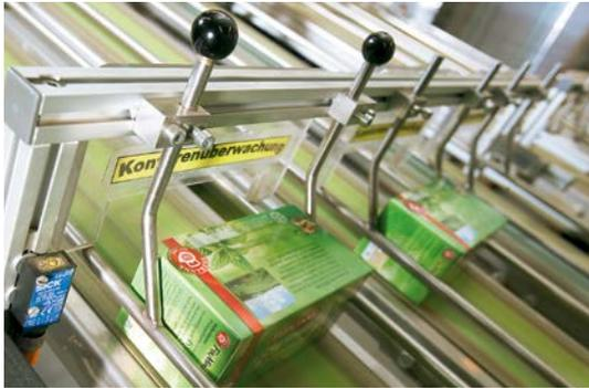
Etiketten- und Aufdrucküberprüfung
