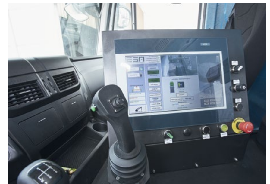
Un monitor nella cabina di guida sorveglia il processo tramite la telecamera esterna e visualizza i dati di processo.
