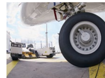
LMS511 misura le ruote dell'aeromobile per individuare il tipo di aeromobile.
