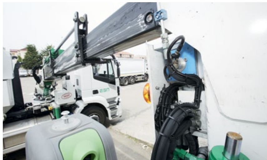
L'encoder a cordino EcoLine rileva in modo affidabile la sporgenza del braccio del gripper.
