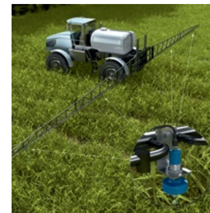
I sensori a ultrasuoni UM30 garantiscono l'altezza di lavoro corretta delle irroratrici.
