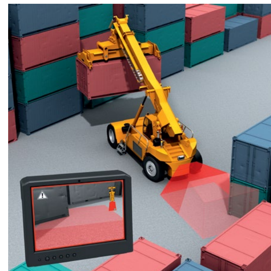
Nei porti, Visionary-B monitora l'area dietro il reach stacker.
