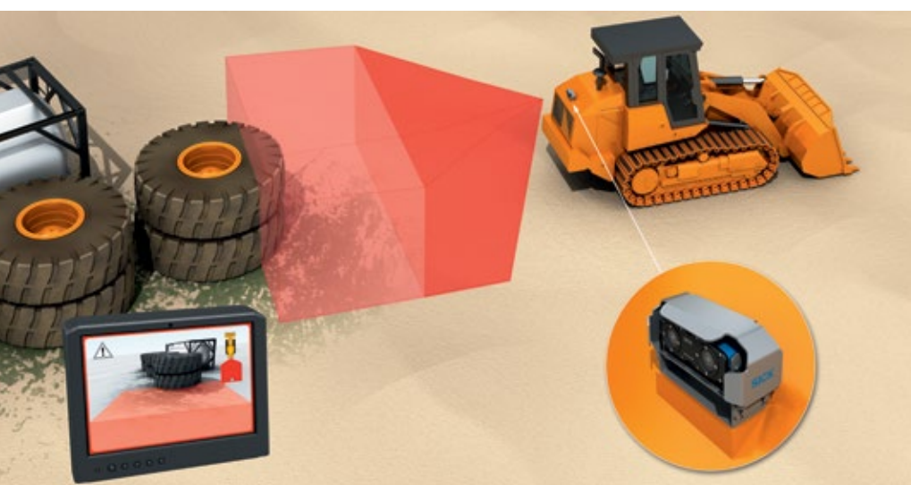
Il sensore di visione 3D Visionary-B rileva in modo sicuro persone e oggetti anche nell'angolo cieco e li segnala.
