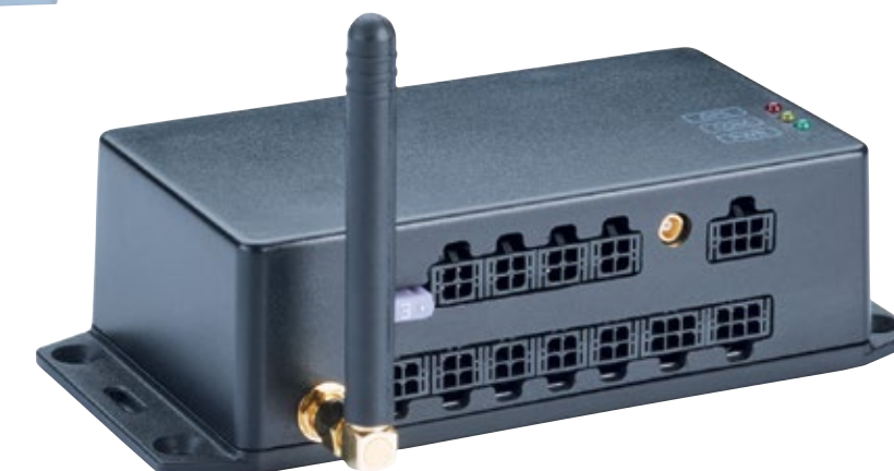
I sistemi della famiglia di prodotti TDC (Telematic Data Collector) raccolgono e trasmettono i dati dei sensori da sistemi mobili e fissi.
