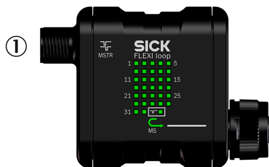
Illustration 46 : Connexions de l'accessoire Flexi Loop MSTR1
