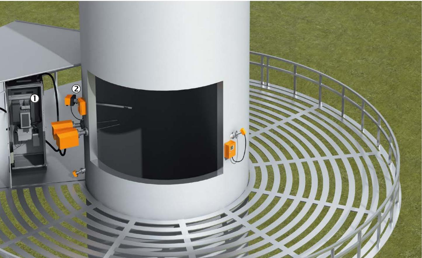
Hierbei wird das Messgas überisokinetisch aus dem Kamin entnommen, über den Säuretaupunkt erhitzt und kontinuierlich gemessen. In einigen Märkten (z. B. Hongkong, China) wird nicht nur die Staubkonzentration, sondern auch die Opazität mit dem DUSTHUNTER T kontinuierlich erfasst.
