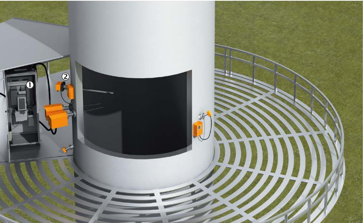
Hierbei wird das Messgas überisokinetisch aus dem Kamin entnommen, über den Säuretaupunkt erhitzt und mit einer Streulichmesszelle kontinuierlich gemessen. In einigen Märkten (z. B. Hongkong, China) wird nicht nur die Staubkonzentration, sondern auch die Opazität mit dem DUSTHUNTER T kontinuierlich erfasst.
