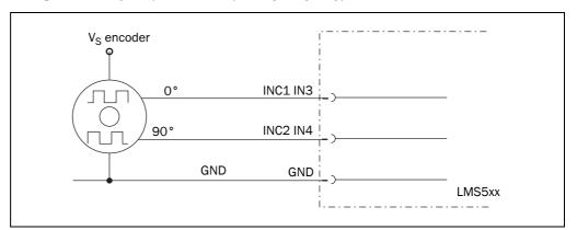
Fig. 56: Wiring encoder inputs
