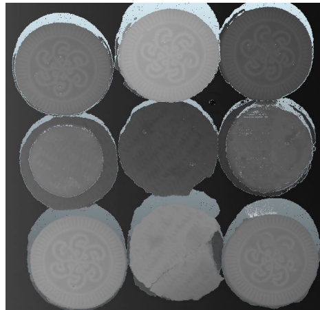
Abbildung 43: 3D-Bild mit Bereichsinformationen als Helligkeit.
