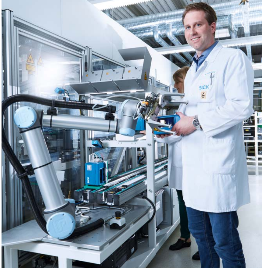
Mit der am Roboter montierbaren 2D-Kamera Inspector PIM60 erkennt der Roboter die Position vorher definierter Objekte.
