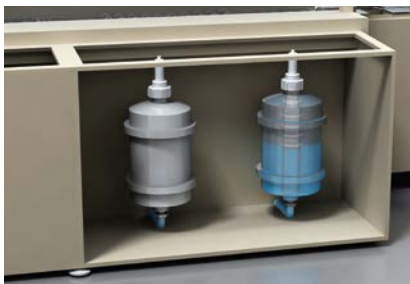
Lagerung von Chemikalien in schlecht zugänglichen Tanks.
