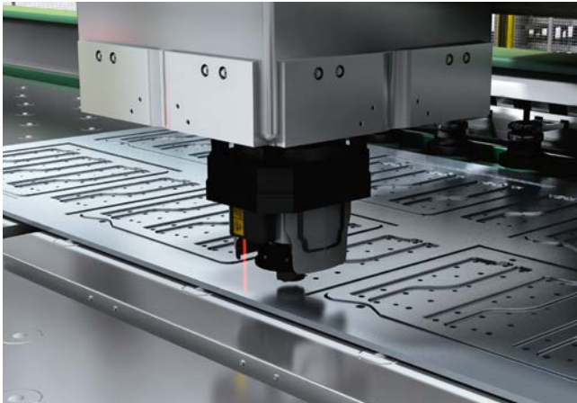
Abbildung 11: Distanzkontrolle am Schneidkopf mit Displacementsensor OD Max
