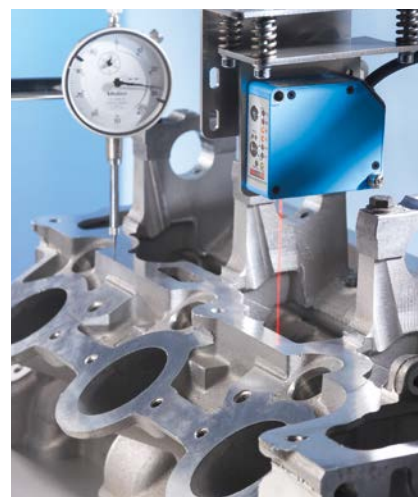
Abbildung 8: Messmethoden: Mechanisch und optisch im Vergleich
