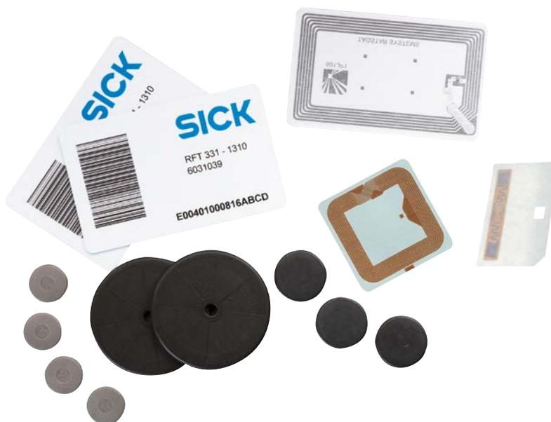
Figura 2: Los transpondedores pasivos HF y UHF RFID de diversas formas facilitan la colocación en objetos y su uso como tarjetas de identificación. Los diseños de antena y chip de las etiquetas UHF y HF difieren considerablemente debido a las diferentes formas en que funciona la transmisión de energía y datos (etiqueta en el extremo derecho: UHF, el resto: HF).
