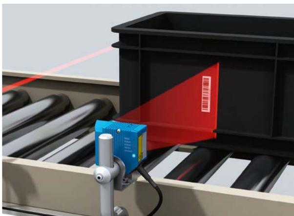
Figura 5: Los escáneres láser están muy extendidos en los almacenes porque identifican de forma fiable los portadores de carga cuando se montan en el lateral del sistema de transporte. El diagrama muestra un escáner de barrido lineal que se activa mediante una barrera fotoeléctrica de reflexión.
