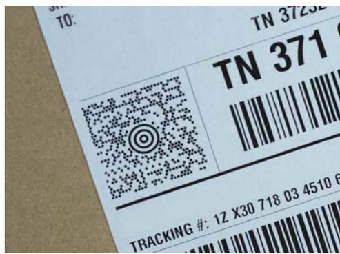
Figura 6: Los servicios de paquetería suelen utilizar una combinación de códigos 1D y 2D (en este caso un código Maxi).
