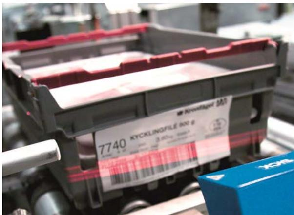
Figura 4: Los escáneres de espejo oscilante leen códigos de barras dentro de un rango especificado, incluso en condiciones de iluminación complejas.
