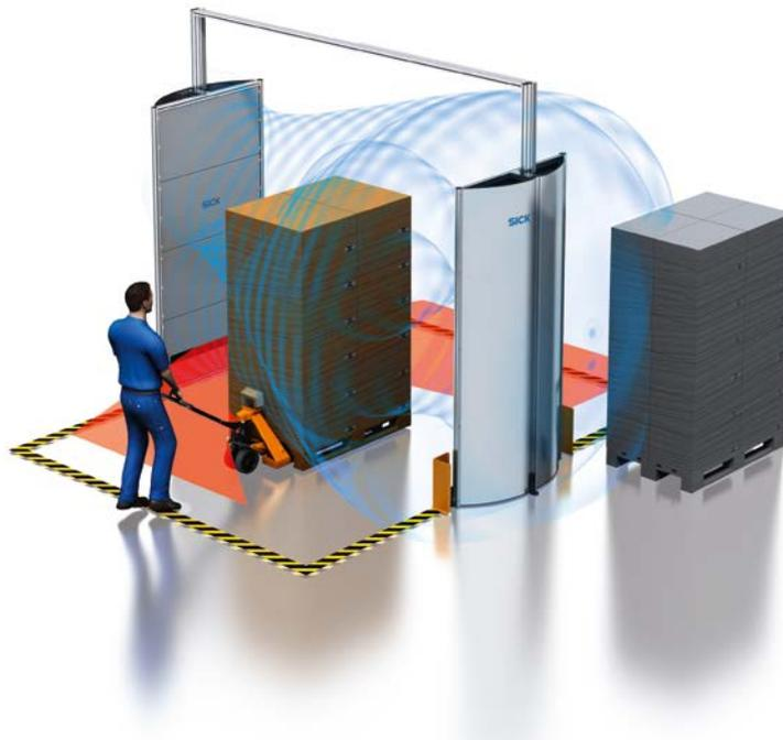
Figura 3. La puerta RFID de SICK (RFGS Pro) identifica objetos marcados con RFID sobre un palé al pasar por la puerta. Las etiquetas fuera del campo de medición se filtran de forma fiable.
