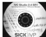
Mit Ringlicht, mehr Kontrast. Jedoch mit einer Blendung auf der glänzenden Oberfläche in der Mitte der Disc.
