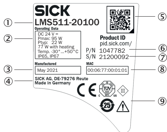
插图 5: 铭牌的结构 (示例)
