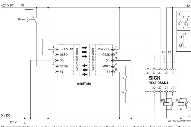
Sicherheitslichtvorhang miniTwin an Sicherheitsrelais RLY3-OSSD1, mit Wiederanlaufsperre und Schützkontrolle
