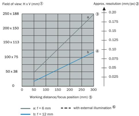
Bei der Applikationsauslegung sind folgende Aspekte zu berücksichtigen: Sichtfeldgeometrie des Geräts und Lage des Sichtfelds im Raum vor dem Gerät. Mögliche Winkel, in denen die Objekte in Bezug auf das Gerät auftreten können. Für den geplanten Arbeitsabstand: resultierende Sichtfeldlänge und -breite sowie die ungefähre Auflösung.
