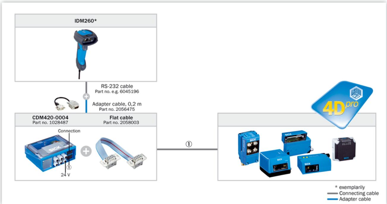
Schéma de raccordement EtherCAT®
