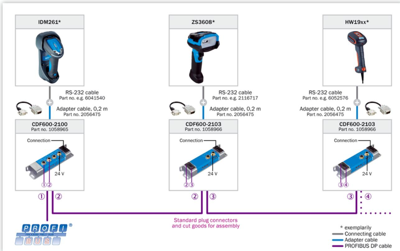
Schéma de raccordement PROFINET IO/RT
