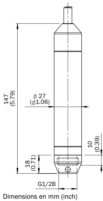
Plan coté Version Enhanced avec câble PUR (profondeur d'immersion jusqu'à 100 m)
