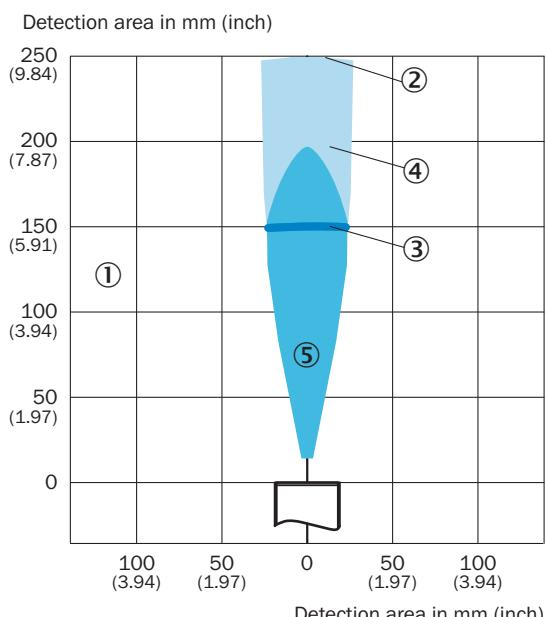
① plage de détection en fonction des propriétés de réflexion, de la taille et de l'alignement de l'objet
