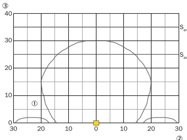
Si l'actionneur se déplace latéralement vers la surface du capteur, respecter une distance minimale de 3 mm. Ceci empêche le déclenchement précoce causé par les zones d'approche latérales.
