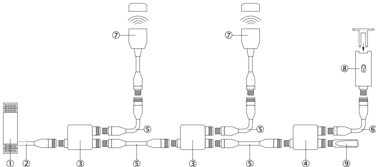
① Système de commande de sécurité Flexi Soft
