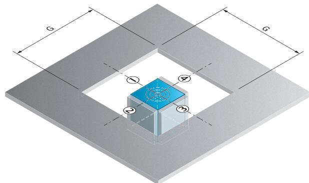
Capteur avec angle de virement pivoté (les valeurs indiquées se réfèrent à une tôle d'acier d'une épaisseur de 1 mm).
