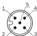
Schéma de raccordement UM18-21xxxExxx Connecteur mâle M12, 5 pôles
