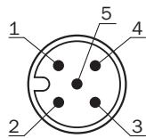
Schéma de raccordement UM18-21xxxCxxx\_Dxxx Connecteur mâle M12, 5 pôles
