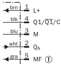
① entrée multifonction / synchronisation et multiplexage/communication Connect+
