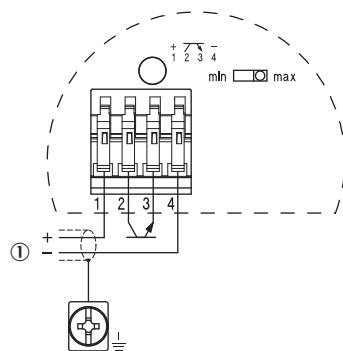
Schéma de raccordement Comportement PNP
