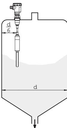
Instructions de montage Orientation de l'écoulement des lames vibrantes
