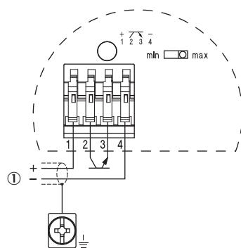
Schéma de raccordement Comportement PNP
