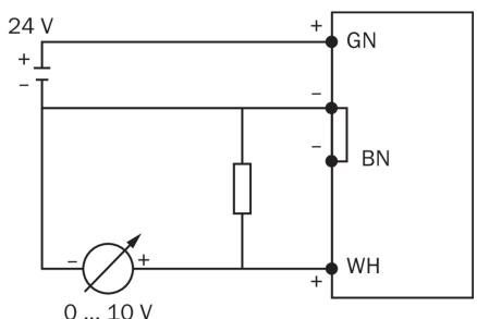
Pour une mesure exacte, la résistance interne du dispositif de mesure doit s'élever à 10 kohms.
