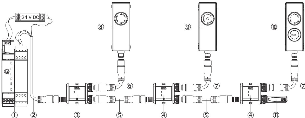
Exemple de câblage Bouton-poussoir de réarmement ER12 et interrupteur d'arrêt d'urgence ES11 sur le relais de sécurité UE43
