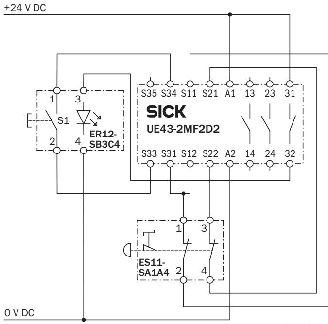
Exemple de câblage Bouton-poussoir de réarmement ER12 et branchement en série de trois interrupteurs d'arrêt d'urgence ES11 sur un système de commande de sécurité Flexi Soft
