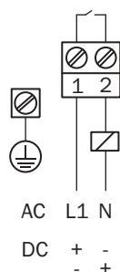
Mode de raccordement LFV300 commutateur sans contact - Pièces électroniques
