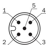
Schéma de raccordement UM30-21x111 UM30-21x114 Connecteur mâle M12, 5 pôles
