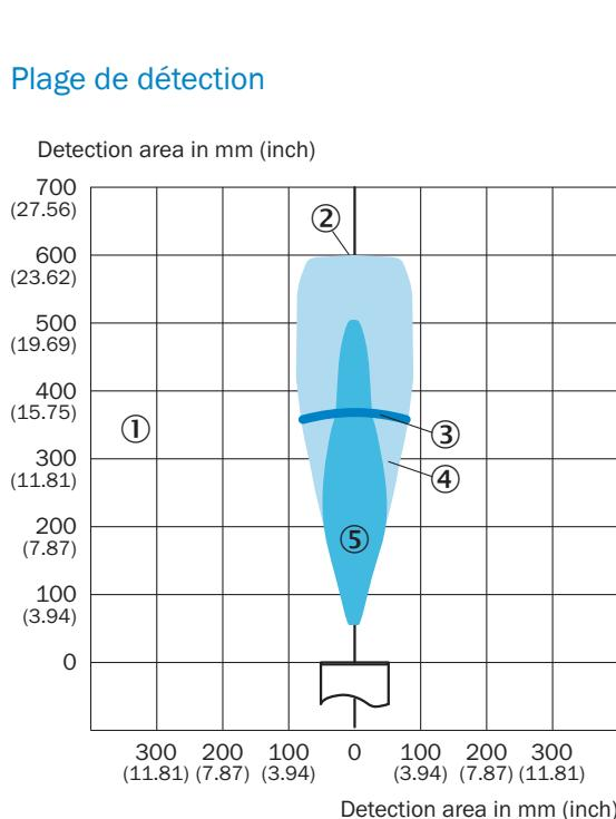
① plage de détection en fonction des propriétés de réflexion, de la taille et de l'alignement de l'objet
