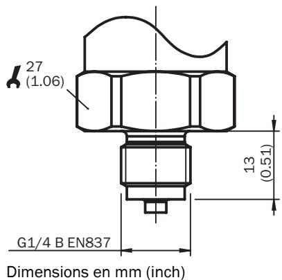
Plan coté Boîtier avec connecteur cylindrique M12 x 1, IP67
