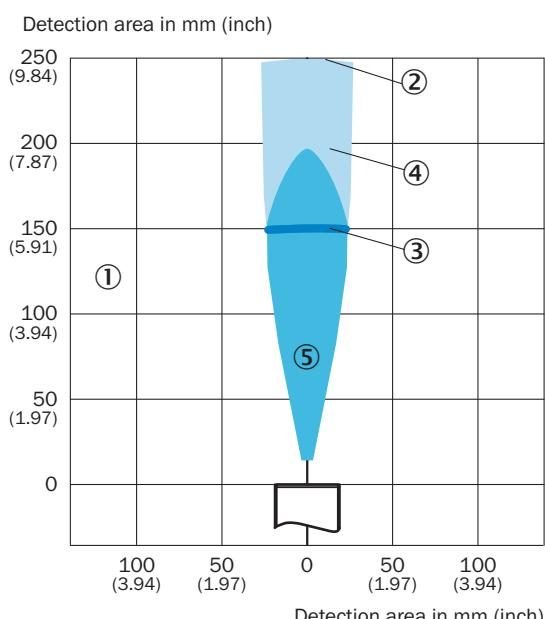
① plage de détection en fonction des propriétés de réflexion, de la taille et de l'alignement de l'objet
